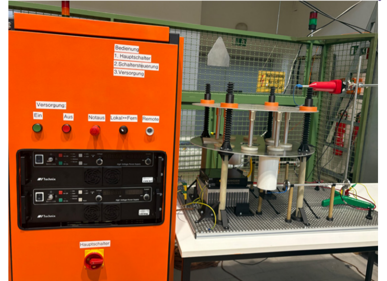
Erster Versuchsstand zur Untersuchung der elektrischen Alterung von Isolierwerkstoffen unter hochfrequenten Spannungsimpulsen.
