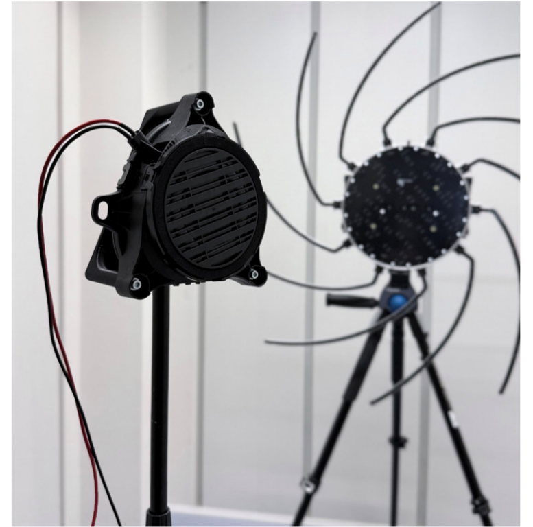
Akustische Vermessung eines AVAS-Lautsprechers im Freifeldraum des Akustiklabors
