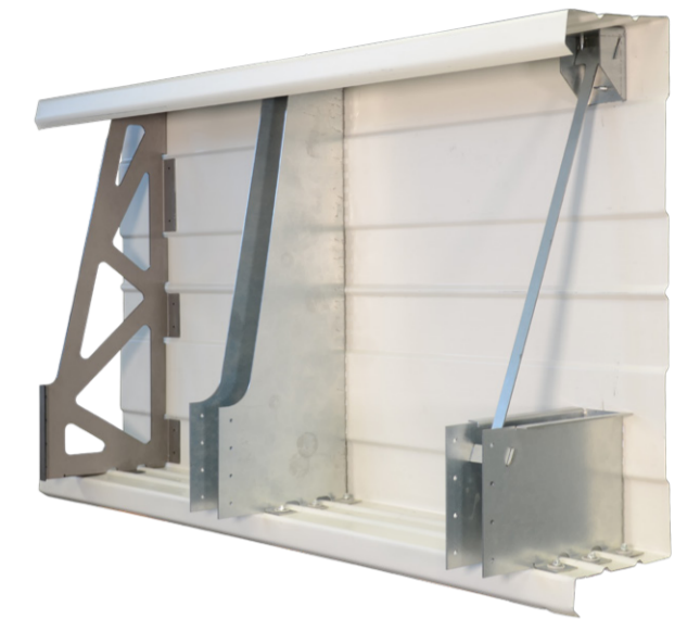
Demonstratoren der Halter in der Stahl-Kassettewand; Spantenhalter- und Zugbandversionen
