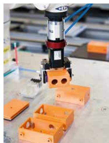
Handhabung von Industriegehäusen mittels 6-Achsroboter
