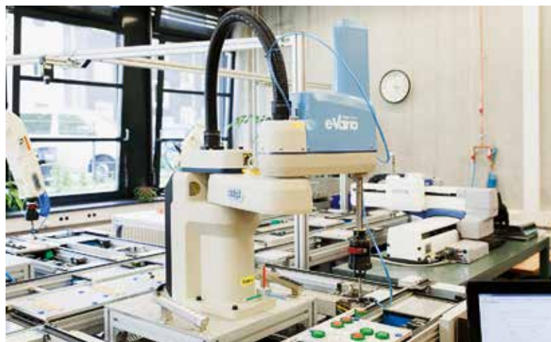
Einblick ins Robotik-Labor: SCARA-Roboter mit „Sauger“ zur exemplarischen Umsetzung einer Palettierungsaufgabe im Laborbetrieb der FH-Dortmund.
