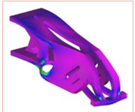
Bild 6: FE-Analyse des Kragträgers mit einer Einzellast
