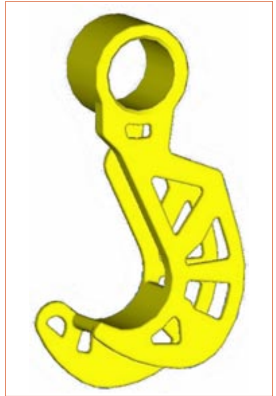
Bild 7: a) Bauraum des Ösenhakens, b) Topologieoptimierung, c) konstruktive Umsetzung
