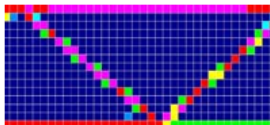
Bild 1: a) Kragträger, b) künstliche Dichteverteilung, c) künstliche Dichteverteilung mit Fertigungsrestriktion
