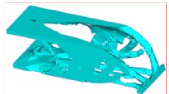
Bild 4: a) Künstliche Dichteverteilung des 3D-Kragträgers, b) Vorentwurf des 3D-Kragträgers
